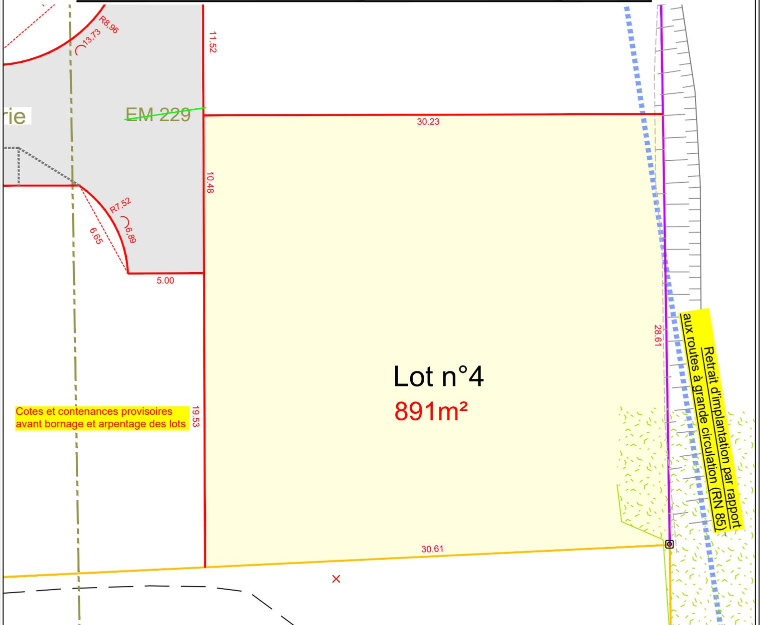
Cotes et contenances provisoires avant bornage et arpentage des lots
